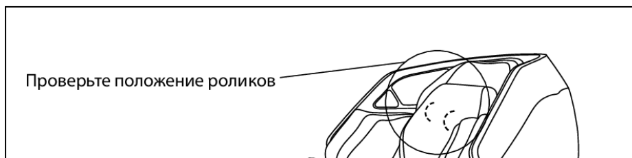
Рисунок 30 — Правильное положение роликов
