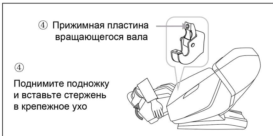
Рисунок 19 — Установка секции для ног
