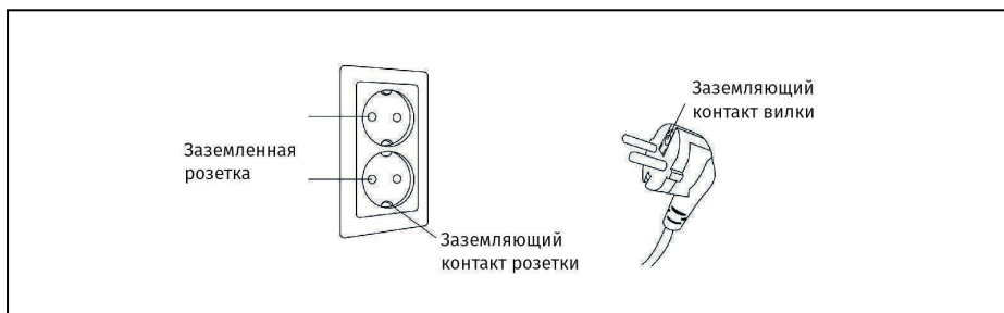
Рисунок 21 — Правильное заземление массажного кресла
