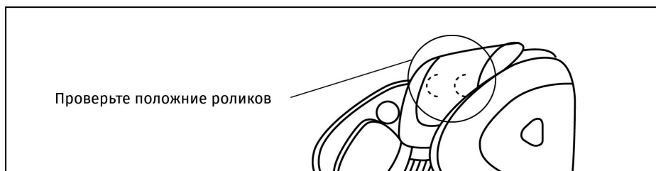
Рисунок 11 — Правильное положение роликов
