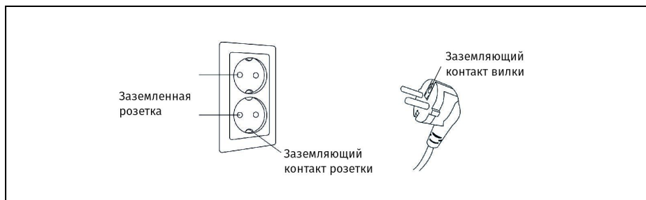
Рисунок 33 — Правильное заземление массажного кресла
