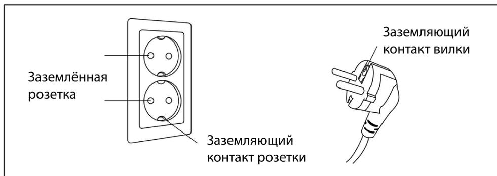
Рисунок 13 — Правильное заземление массажного кресла
