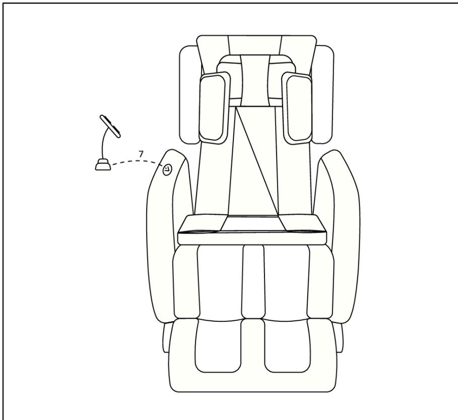
Рисунок 9 - Крепление подставки для планшета управления
