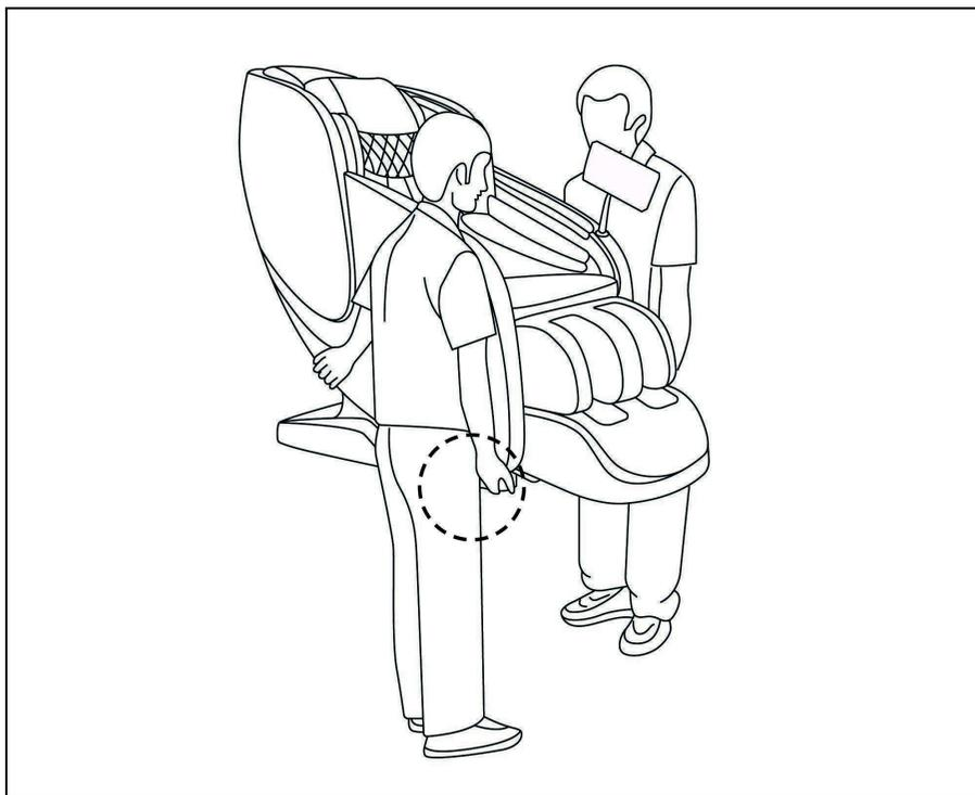
Рисунок 5 — Перемещение массажного кресла без использования транспортировочных роликов
