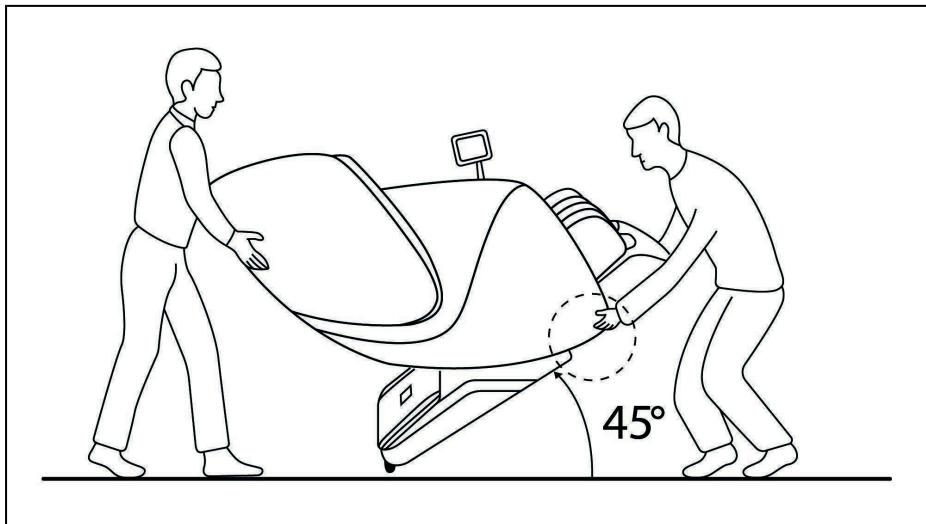
Рисунок 4 – Перемещение массажного кресла с помощью транспортировочных роликов
