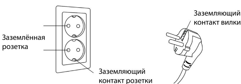
Рисунок 13 — Правильное заземление массажного кресла
