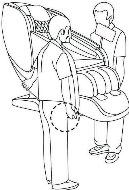
Рисунок 5 – Перемещение массажного кресла без использования транспортировочных роликов
