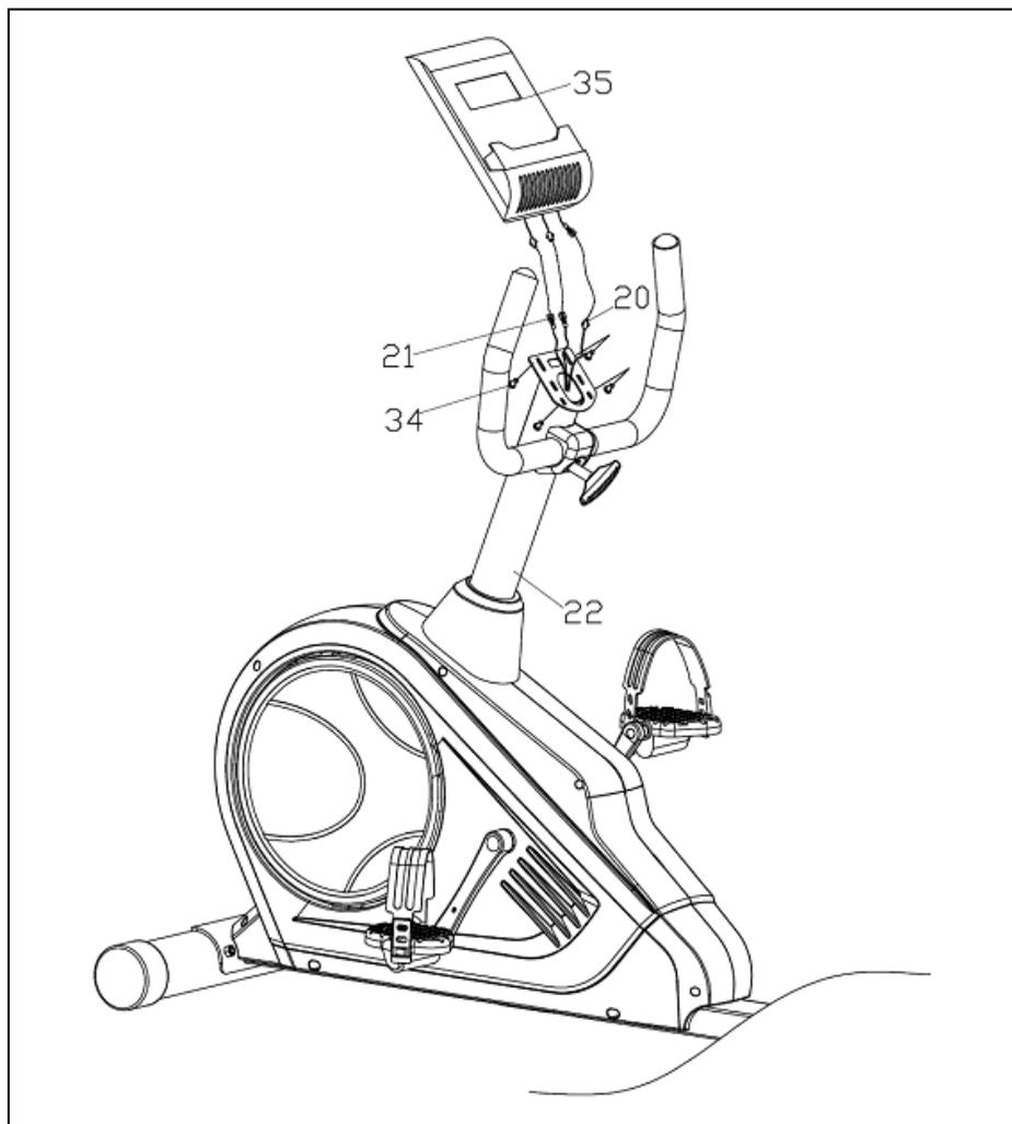
Рисунок 6 – Установка консоли
