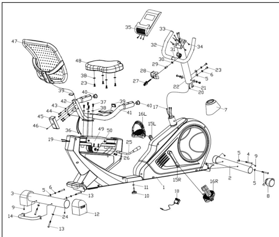
Рисунок 1 – Схема тренажера в разобранном виде
