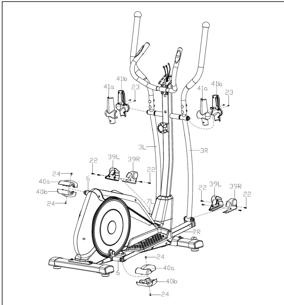
Рисунок 7 – Крепление кожухов
