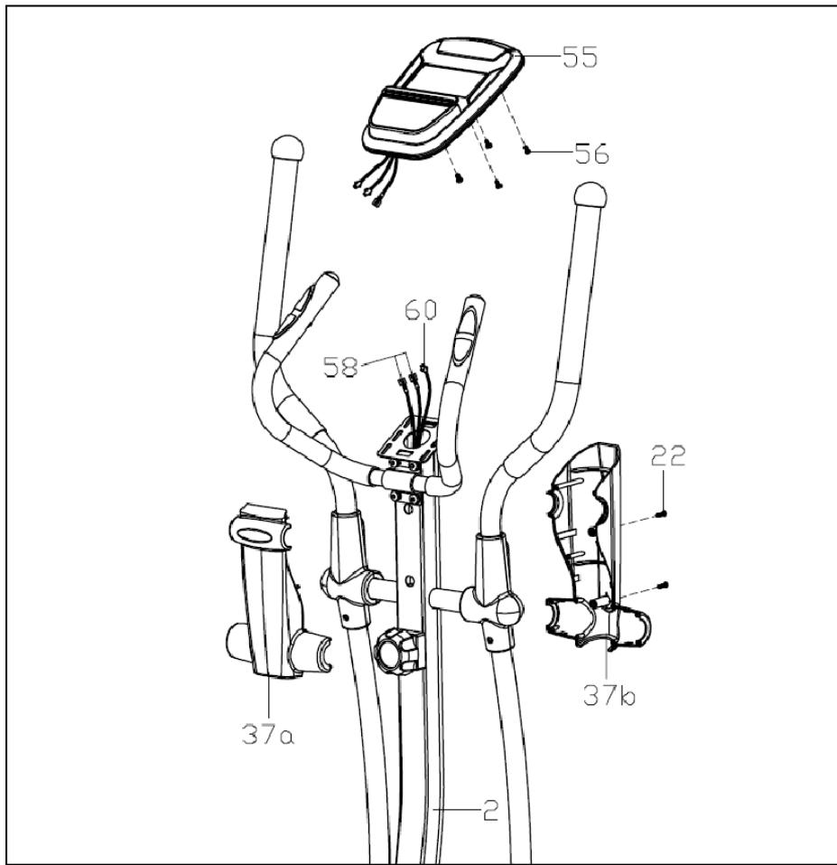
Рисунок 8 – Установка консоли
