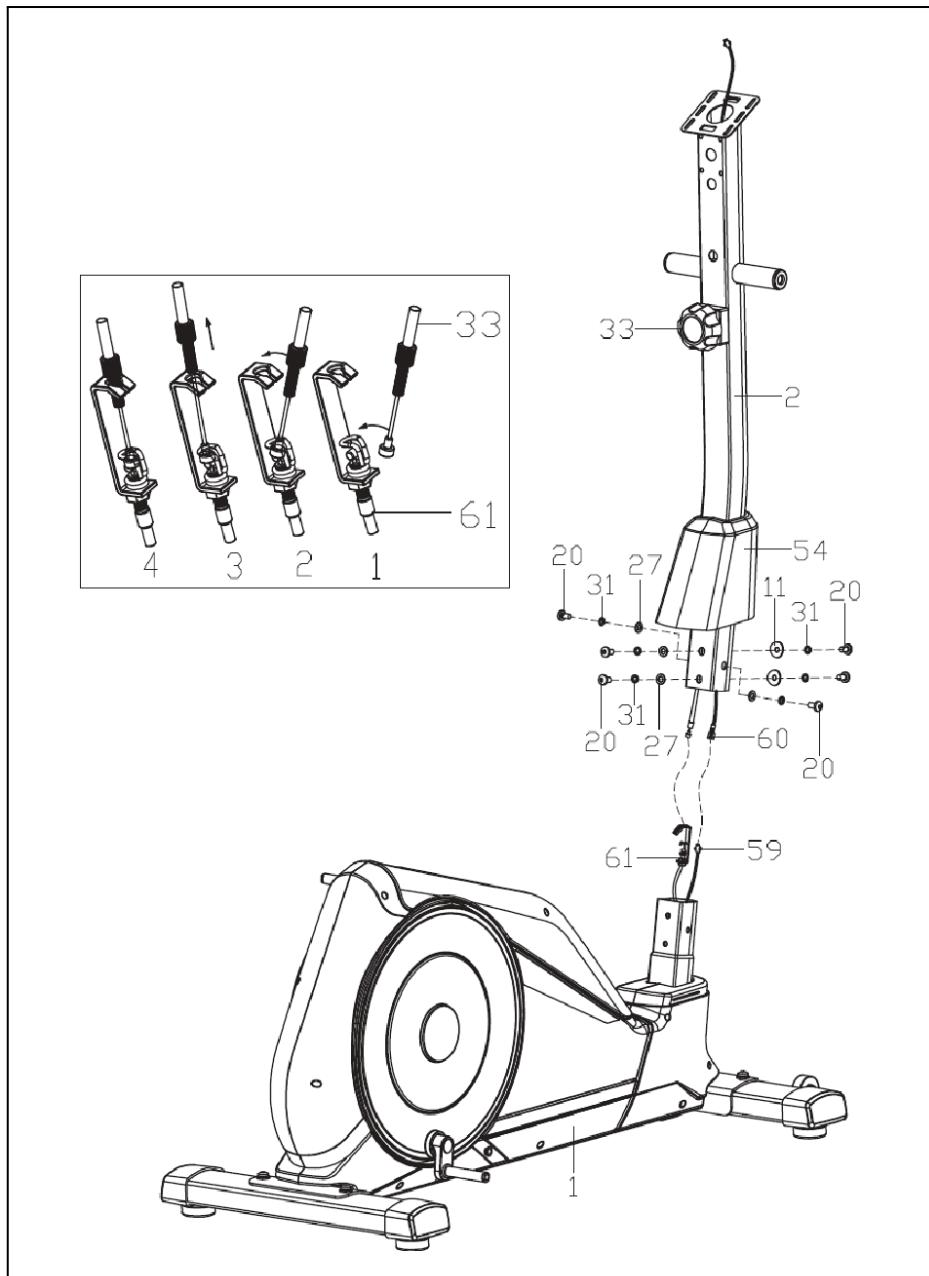
Рисунок 4 – Установка стойки консоли и системы нагружения
