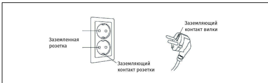
Рисунок 14 — Правильное заземление массажного кресла
