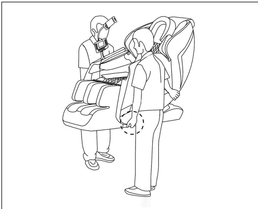
Рисунок 5 — Перемещение массажного кресла без использования транспортировочных роликов
