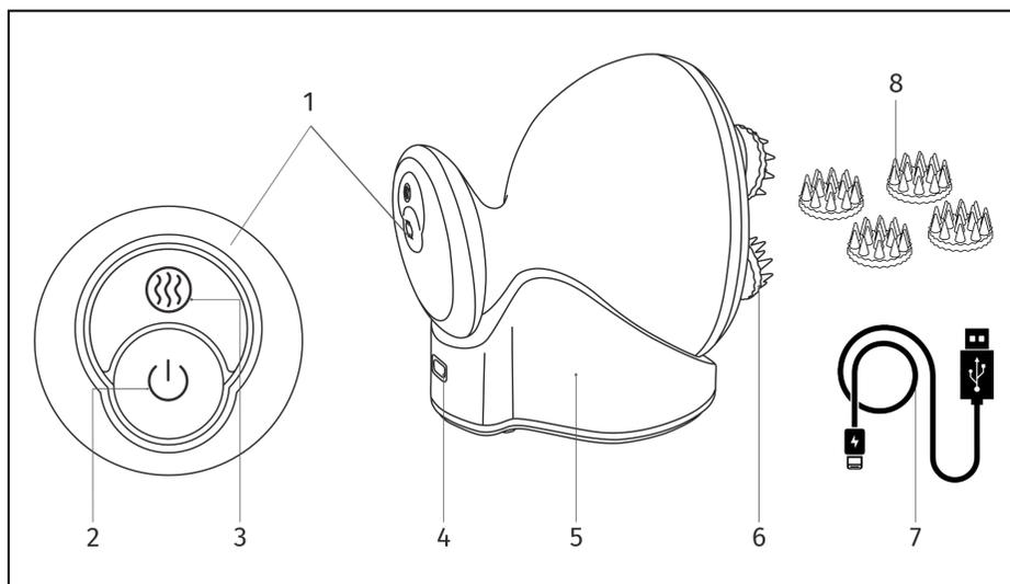
Рисунок 1 – Устройство массажера
