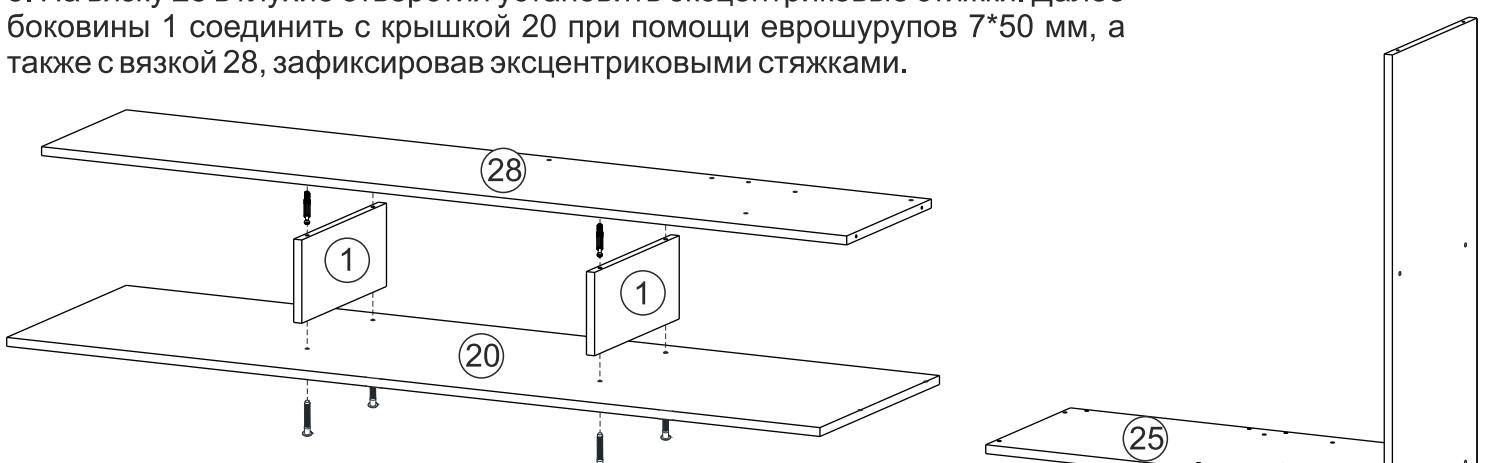
6. Далее соединить между собой конструкции, собранные в п. 4 и 5 при помощи еврошурупов 7\*50 мм (см. рис.).
