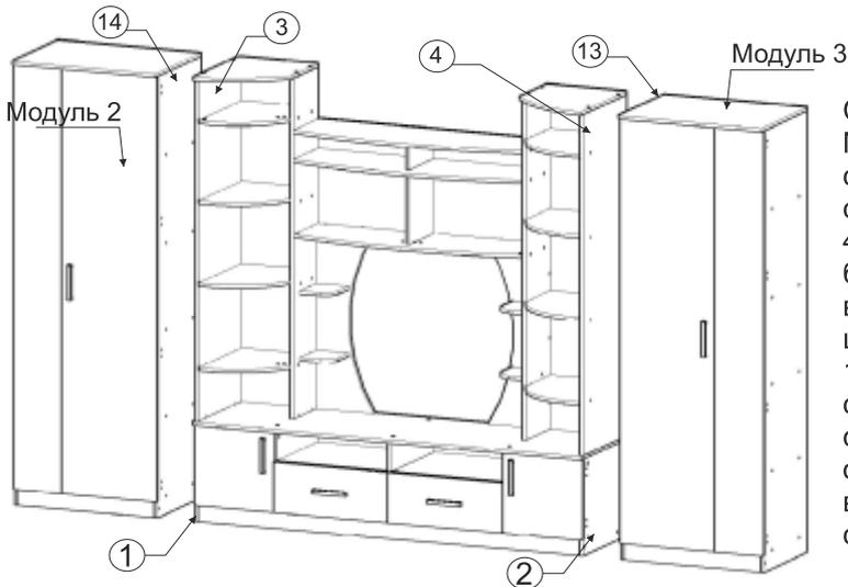
Скрепить между собой Модуля 1, 2 и 3 секционными стяжками. Для этого просверлить в боковине 1 и 2, 3 и 4, а также на одной из двух боковин 13 и 14 (в зависимости от расположения шкафов) на расстоянии около 10-15 см от каждого угла стенок два сквозных отверстия диаметром 5 мм на одном уровне. Гайки стяжек входят в отверстие, и крепеж свинчивается.
