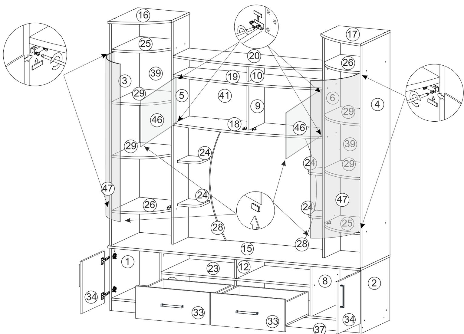
12. Навесить створки 34, предварительно закрепив на нем петли шурупами 4\*13 мм. Для установки ручек на створки необходимо досверлить глухие отверстия диаметром 5 мм насквозь. Далее закрепить ручки саморезами.
