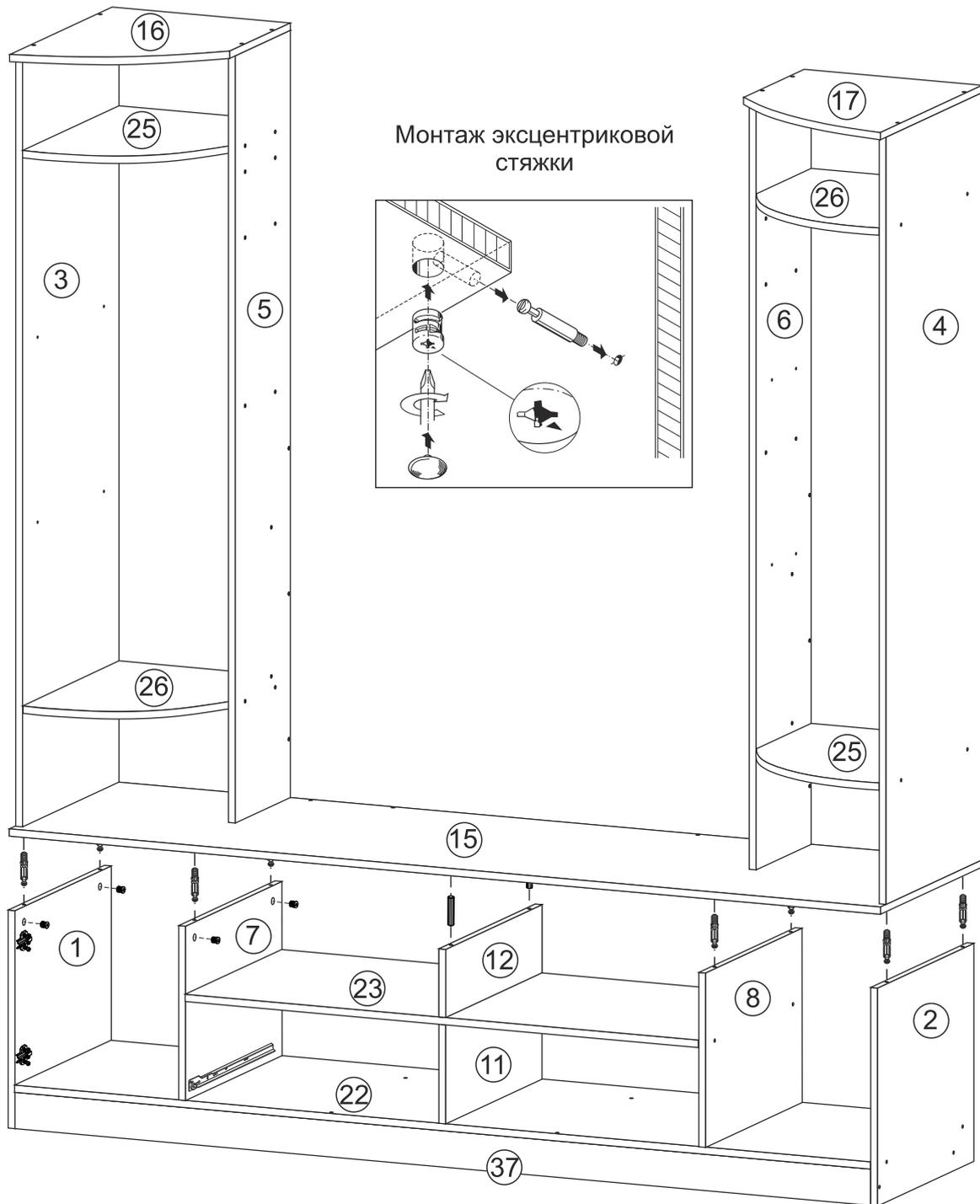
8. Задники 28 соединить с крышкой 15 и боковинами 5 и 6 при помощи еврошурупов 7\*50 мм. Далее установить конструкцию из деталей 18, 19, 20 на задники и также соединить еврошурупами 7\*50 мм (см. рис на стр 7). Вязки 24 скрепить с задниками 28 и боковинами 5 и 6, используя еврошурупы 7\*50 мм.
