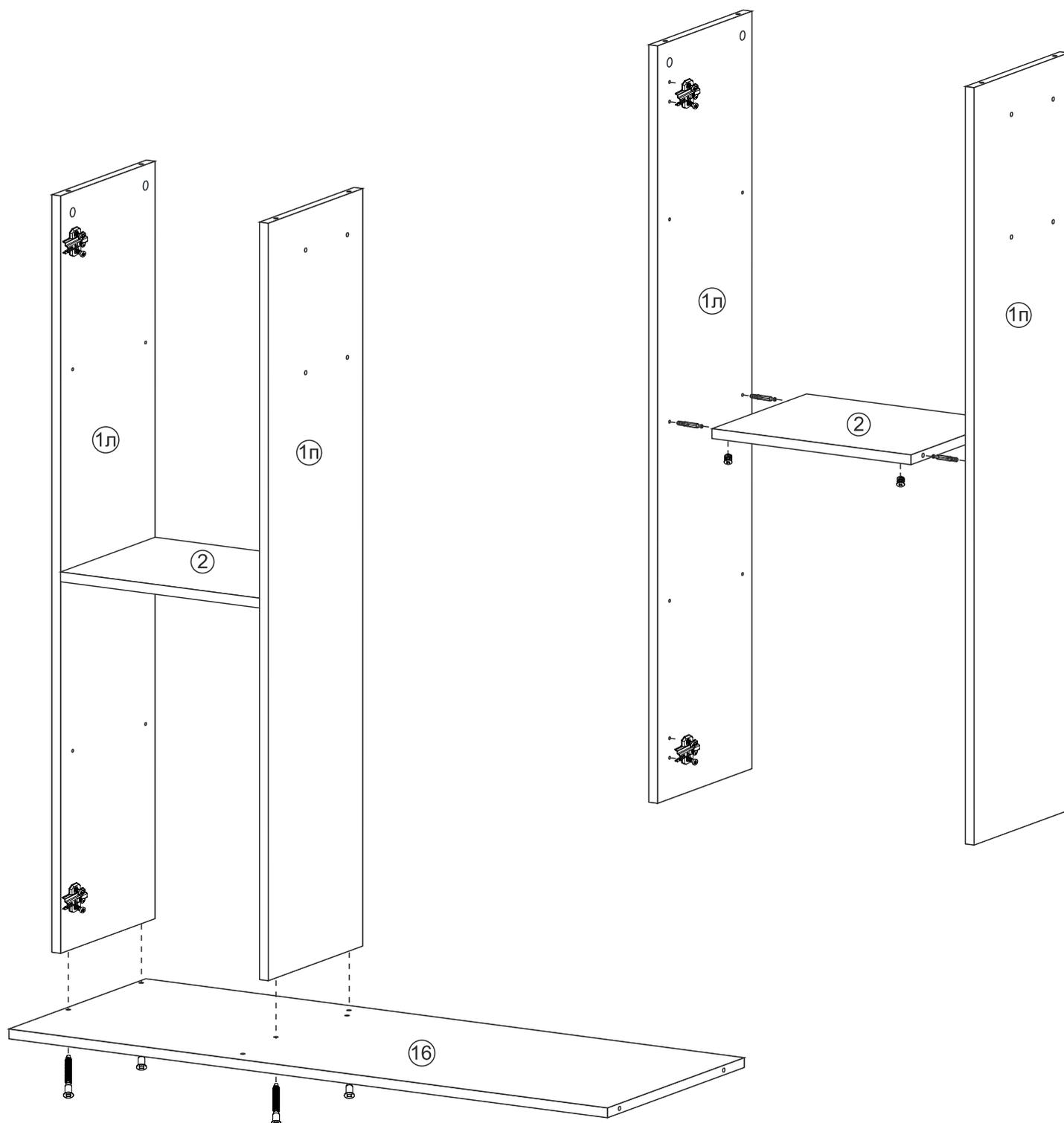
5. На боковину 12 установить эксцентрики, на боковину 11 - дюбеля двойные. Подготовленные боковины соединить между собой с вязками 13 и 16, и зафиксировать эксцентриковыми стяжками (см. рис ниже).
