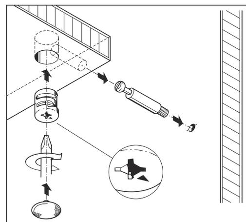
6. На вязку 16 установить эксцентрики (см. рис. ниже). Далее прикрепить к ней боковины 14 и зафиксировать эксцентриковыми стяжками.
