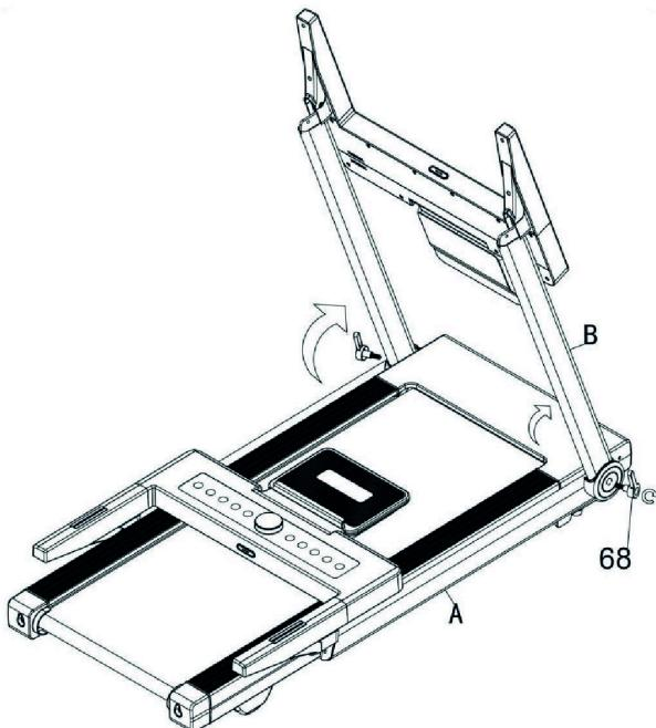
Рисунок 2 – Установка стоек беговой дорожки
