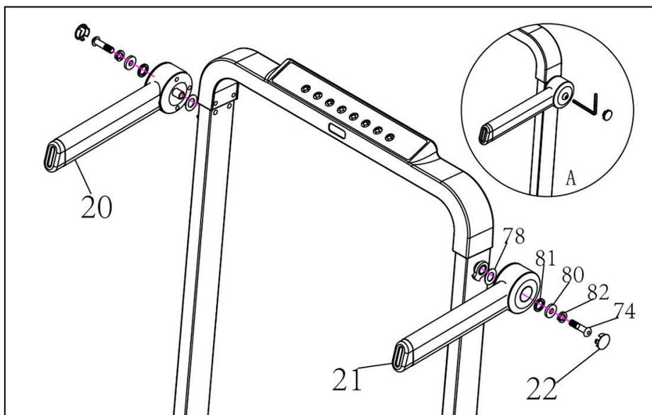
Рисунок 4 — Фиксация поручней
