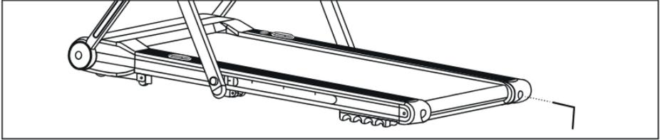
Рисунок 8 – Центровка бегового полотна
