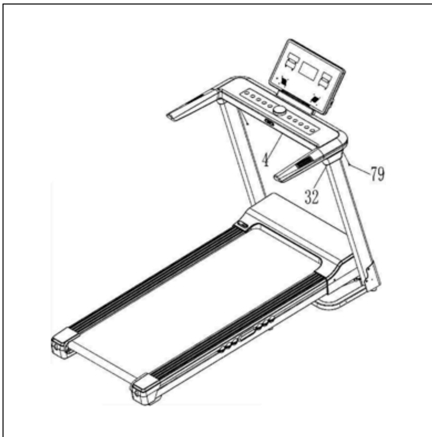
Рисунок 4 — Установка декоративных заглушек под консолью
